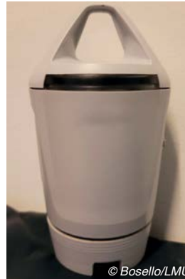
Abb. 40: Beispiel-Sensor für die konstante Überwachung der Schadgase, Lufttemperatur und Luftfeuchtigkeit im Stall
