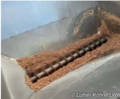
Abb. 78: Mazerator für Eier mit nicht geschlüpfen Küken (links) und Zerkleinerung der Eierschalen (rechts)
