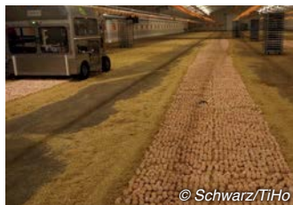
Abb. 32: Vorgebrütete Eier werden mit dem NestBorn® Roboter auf das Einstreubett gesetzt
