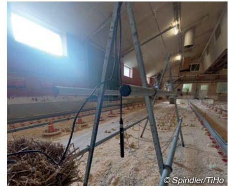
Abb. 98: Mikrophon am A-Reuter in der ersten Lebenswoche für kontinuierliche Audioaufnahmen
