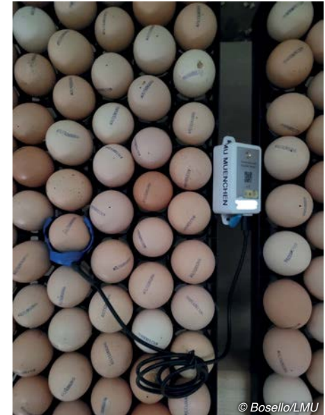
Abb. 41: Beispiel-Sensor für die Messung der Eierschalentemperatur
