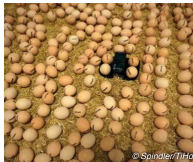
Abb. 54: Vier Eier in firmeneigenem NestBorn® Eierschalensensor
