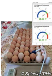
Abb. 10: Eierschalensensor am Ei und Anzeige-Bildschirm aus der App zur Überwachung
