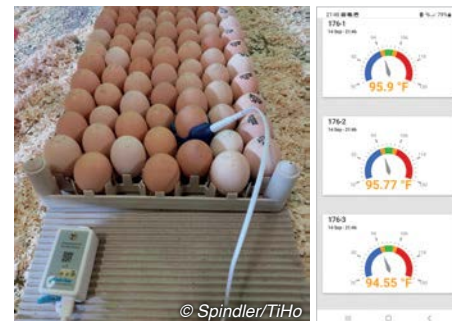
Abb. 58: Mach-Sens Eierschalentemperatur-sensor inkl. App-Ansicht
