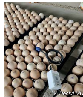
Abb. 55: Sensor für Eierschalentemperatur im Stall ausgelegten Horden
