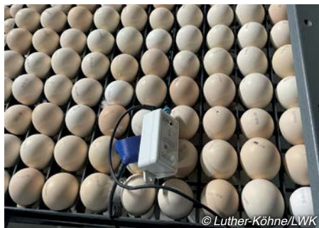
Abb. 56: Eierschalensensor auf einer Schlupfhorde im X-Treck®-System
