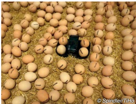
Abb. 38: Von der Firma NestBorn® mitgelieferter Eierschalensensor für 4 Eier
