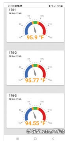
Abb. 37: App-Ansicht der Mach-Sens Sensoren mit farblicher Kontrollskala für eine optimale Eischalentemperatur
