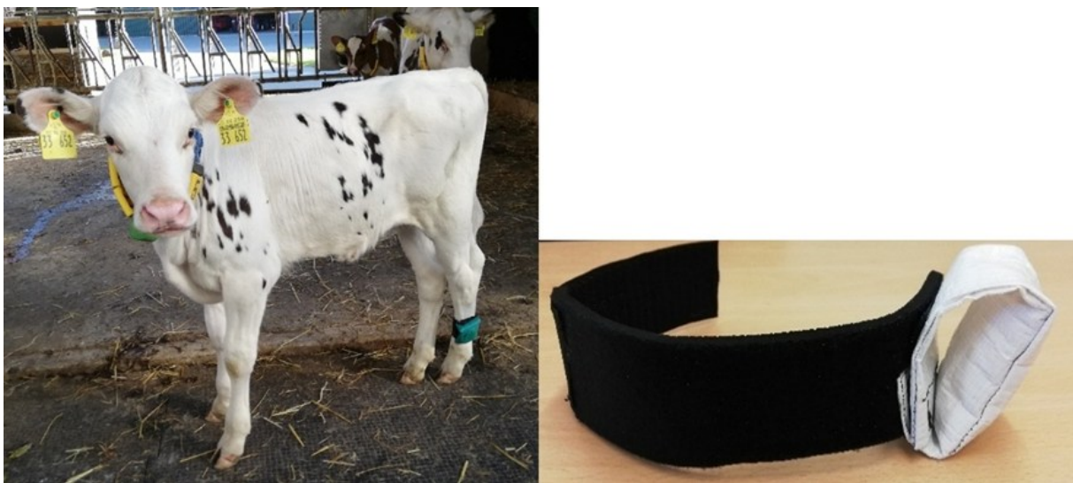
Abbildung 8a: Sitz der HOBOW-Datenlogger am Kalb. Die Tasche zum schnellen Anbringen und Abnehmen des Beschleunigungssensors besteht aus einer wasserdichten Hülle und einem weichem Gummiband, das mit einem Klettverschluss versehen ist. Damit ist die Nutzung bei Kälbern unterschiedlicher Größe möglich ohne die Haut der Tiere zu schädigen oder sie in ihrem Bewegungsverhalten zu beeinträchtigen.
