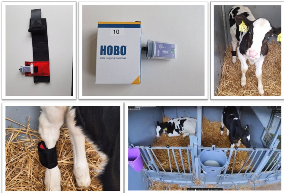
Abbildung 119 Darstellung der Sensoren und der Anbringung am rechten Hinterbein sowie der begleitenden Videoaufnahmen
