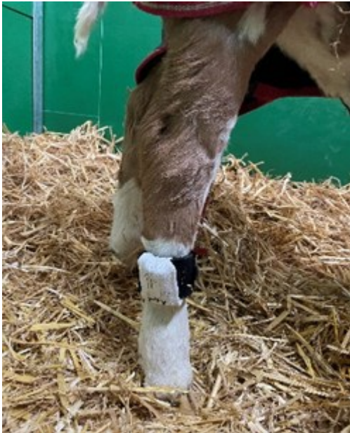
Abbildung 43: HOBO Beschleunigungssensor am rechten Metatarsus eines Kalbs.
