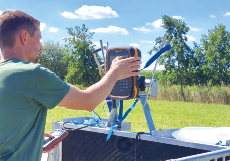
Abb. 29: Durch die Verknüpfung der Waage mit dem Lesegerät werden die erfassten Gewichte direkt den Daten des jeweiligen Einzeltiers zugeordnet.
