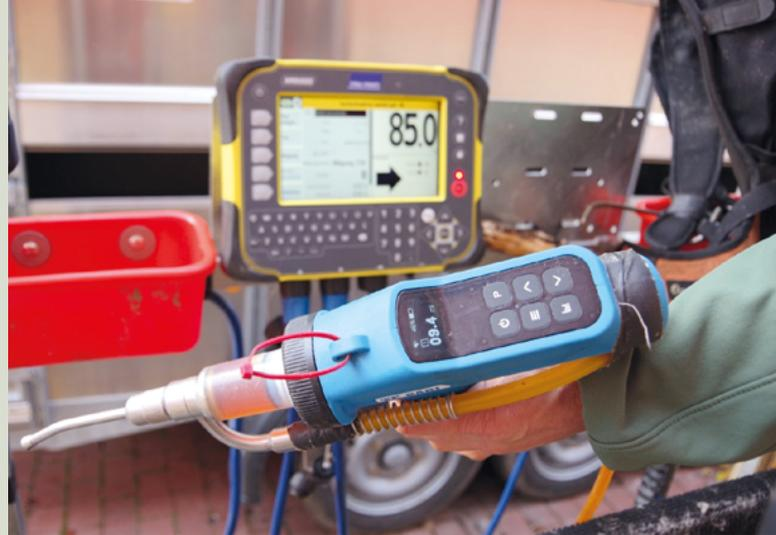
Abb. 30: Die intelligente Dosierspritze dosiert TAM automatisch entsprechend dem erfassten Gewicht auf der Waage. So wird eine Über- oder Unterdosierung vermieden.
